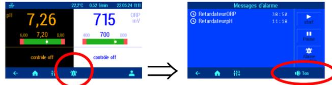
En appuyant sur le bouton « Tonalité d'alarme », l'alarme sonore peut être désactivée ou activée.
